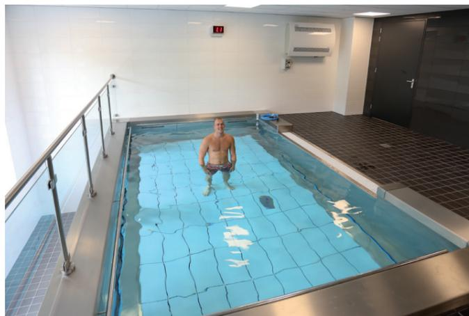
ムによって水が適切に消毒され、水の循環が不十分なデッドポケットがプール内に存在しないということです。ステンレス鋼にはバクテリアが付着しにくいことから、モジュール式プールは考えうる限り市場で最高の衛生性能を備えています。
