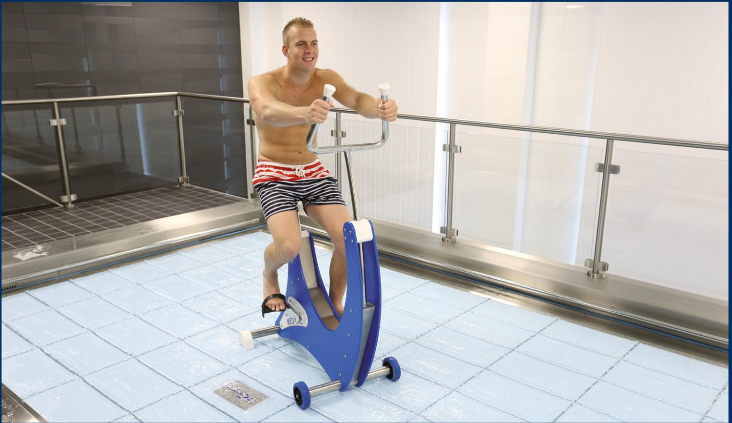
la bicicleta sumergible de EWAC está diseñada para realizar ejercicios de ciclismo en el agua con propósitos de rehabilitación. Está equipada un único mecanismo de resistencia el cual causa que la resistencias se incremente exponencialmente con la velocidad del pedaleo. El arco está fabricado con acero inoxidable pulido 316 siendo ideal para el uso de la rehabilitación en agua.
